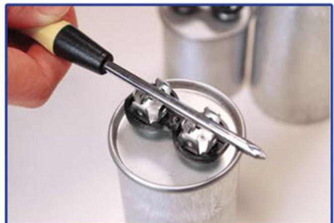
خازن در حال دشارژ شدن
