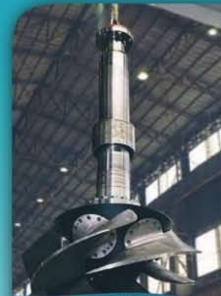
پمپ شناورهای ابارا در ایستگاه انتقال سیلاب شوموگاوا - توکیو ۱۸/۰۰۰ مترمکعب در ساعت و قطر ۳۷۵ میلی متر
